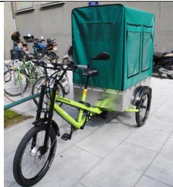
Benne fermée en Tôle d'aluminium
